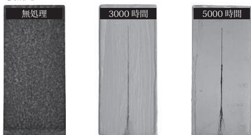
写真-3 錆処理をした試験板としない試験板の 試験結果
